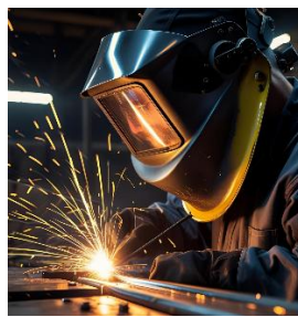
ภาพการเชื่อมอาร์กไฟฟ้าด้วยลวดเชื่อมมีสารพอกหุ้ม
